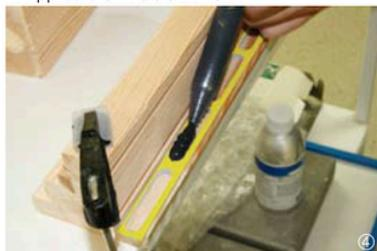
5. Rimuovere l'adesivo in eccesso con una spatola. Evitare di comprimere il nastro durante la rimozione, in modo da ottenere la necessaria altezza di adesivo nelle asole.
