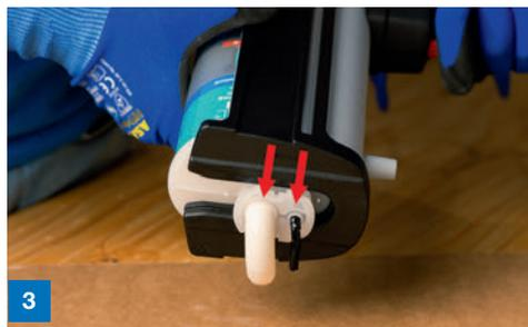
3 Material **ohne** Statikmischer ausdrücken, bis bei **beiden** Öffnungen Material austritt
