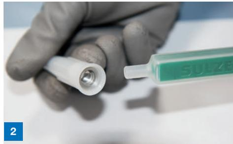
2 Eingeschraubter Gewindeaufsatz in der Standardkartuschendüse
