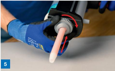
5 Statikmischer mit der Überwurfmutter fixieren
