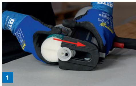
1 Einlegen der side-by-side Kartusche in die Pistole
