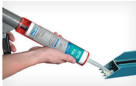
Bei der Verwendung von 1K-PU-Klebstoffen kann eine feuchte Oberfläche der Fügepartner die Durchhärtung unterstützen. Besprühen Sie die zu klebenden Teile leicht mit Wasser, tragen Sie OTTOCOLL® P 86 auf und fügen Sie sie innerhalb der Hautbildungszeit von ca. 20 Minuten zusammen. Die zu klebenden Werkstoffe müssen bis zur Aushärtung des Klebstoffes fixiert werden. Die geklebten Teile sind nach ca. 2 Stunden belastbar.
