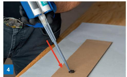
4 Befüllen des Statikmischer mit Klebstoff und Homogenität der Mischung prüfen
