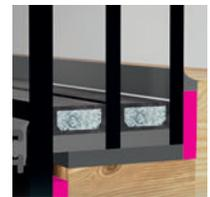
Stufenklebung auf Position 2
