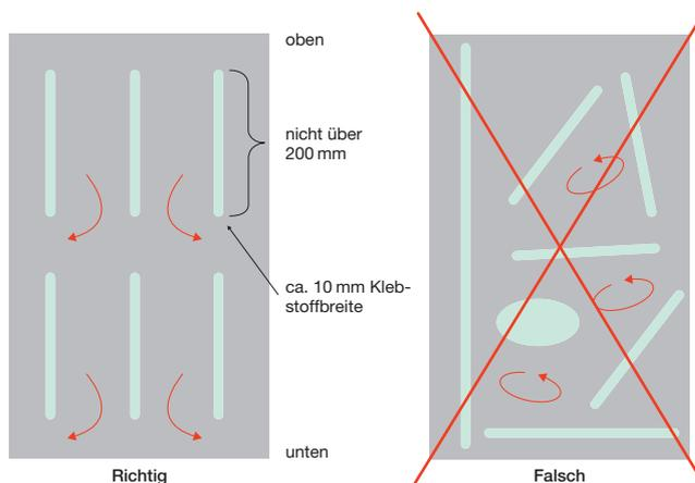
Ein Mindestabstand zwischen Spiegel und Untergrund von 1,6 mm ist zwingend einzuhalten, um das Einsperren des Vernetzer-Spaltprodukts in der endgültigen Position des Spiegels zu vermeiden. Dieser lässt sich auf zweckmäßigste Weise durch das Aufkleben von Abstandshaltern erreichen. Es sind die vom Institut des Glaserhandwerks in Hadamar geforderten Mindesthinterlüftungsabstände ([www.glaserhandwerk.de](http://www.glaserhandwerk.de)) für Spiegel gültig.
