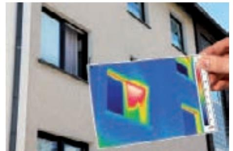
Infrarotaufnahmen machen Wärmebrücken an Gebäudefassaden sichtbar.
