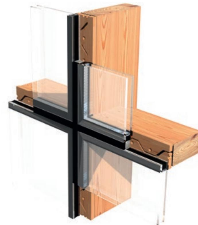
Konstruktionsprinzip von UNIGLAS® | FACADE mit Pfosten-Riegel-Konstruktion, Koppelleiste und Isolierglas.
