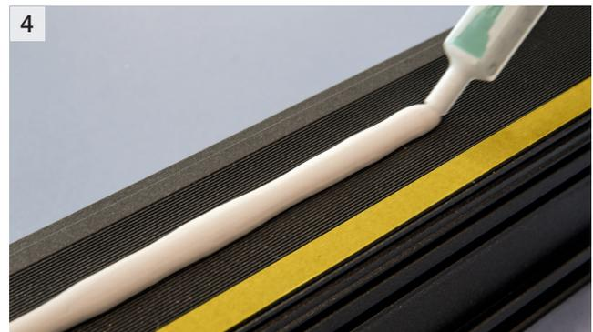
4 OTTOCOLL® M580 gemäß Anleitung aktivieren und als ca. 8 mm Raube auf Füllungsrand oder Flügel auftragen – mind.  $\frac{3}{4}$  der Klebefläche mit 1 mm Klebstoff benetzen; innerhalb von 5–10 Min. weiterverarbeiten
