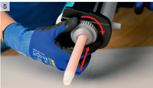
5 Statikmischer mit der Überwurfmutter fixieren
