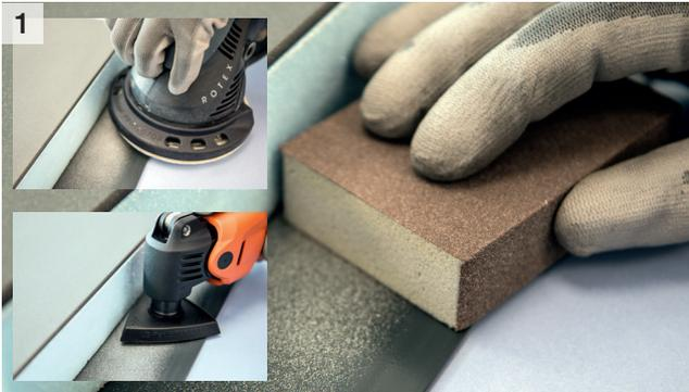
1 Oberfläche anschleifen (Körnung 100 bzw. Bürste), Schleifstaub absaugen – Klebefläche muss danach matt sein
