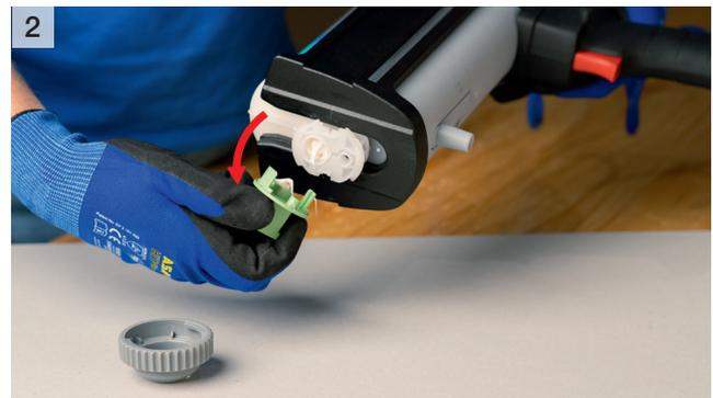
Überwurfmutter abschrauben und Stopfen entfernen
