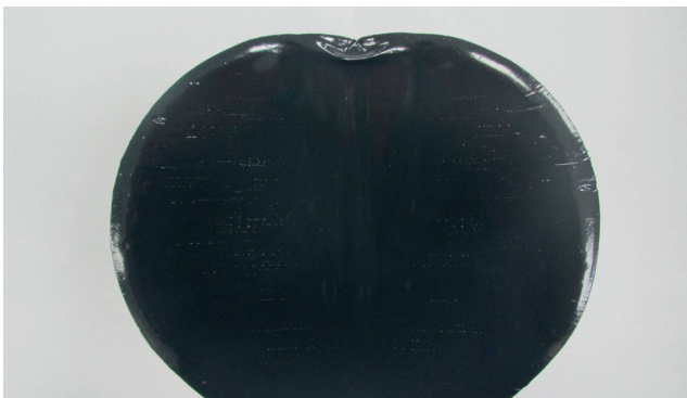
Mischbild bei Verarbeitung über eine Misch- und Dosieranlage
