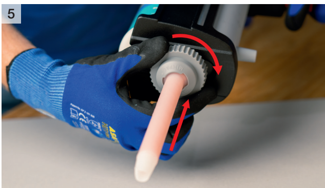
Statikmischer mit der Überwurfmutter fixieren
