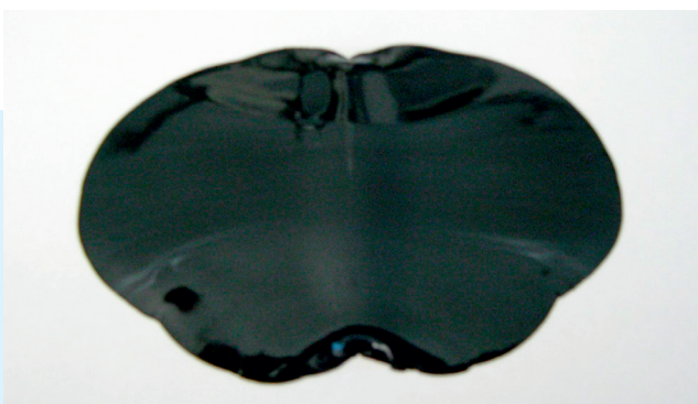
Mischbild bei Kartuschenverarbeitung
