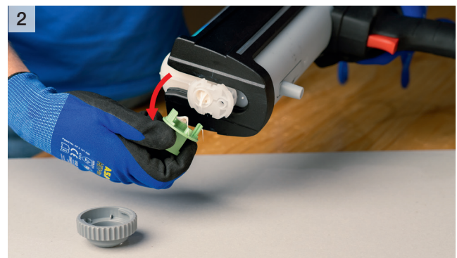
Überwurfmutter abschrauben und Stopfen entfernen
