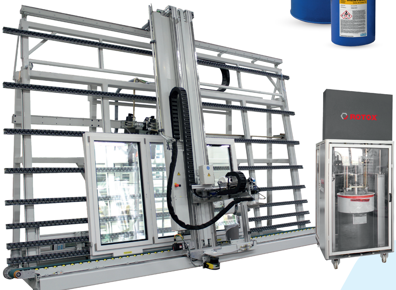
Automatische Verarbeitung von OTTOCOLL® S81/ OTTOCOLL® S670; z. B. mit dem automatischen Glasklebeautomat GKA 242 der Firma ROTOX GmbH
