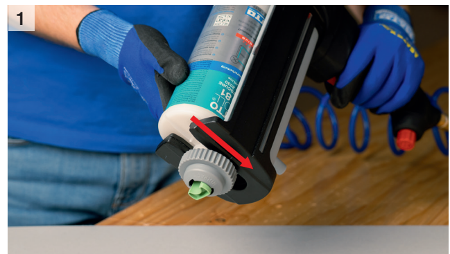
Einlegen der BlueLine Kartusche in die Pistole
