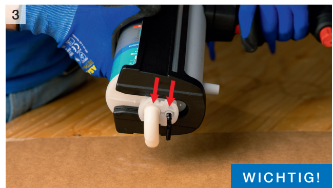
Material ohne Statikmischer ausdrücken, bis aus beiden Öffnungen Material austritt
