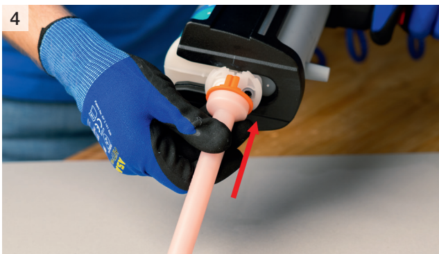
Material abwischen und Statikmischer aufsetzen
