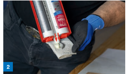
2 Material ohne Statikmischer ausdrücken, bis aus beiden Öffnungen Material austritt
