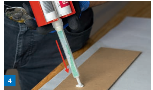
4 Den Statikmischer mit Klebstoff befüllen und Homogenität der Mischung prüfen (siehe Verarbeitungsbegleitende Qualitätskontrollen 2K-Produkte)
