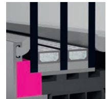
Überschlagsklebung auf Position 1
