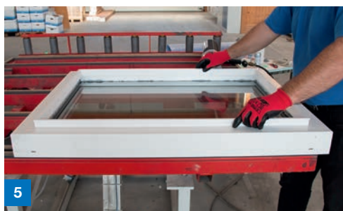
5 Einlegen der Glashalteleisten
