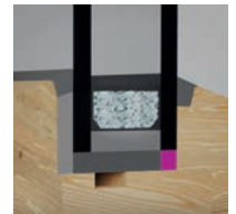
Abdichtung am Flügelrahmen hinter der Glashalteleiste
