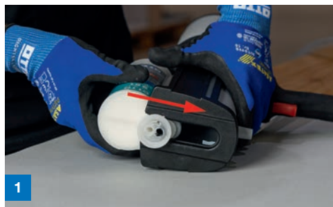
Einlegen der side-by-side Kartusche in die Pistole
