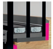
Stufenklebung auf Position 2
