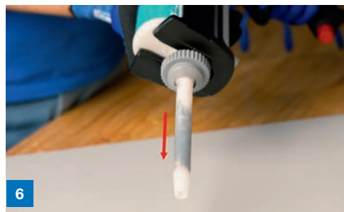
6 Befüllen des Statikmischers mit Klebstoff. Homogenität der Mischung prüfen (siehe Verarbeitungsbegleitende Qualitätskontrollen 2K-Produkte)
