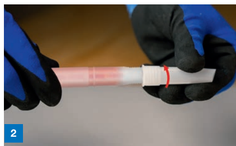
2 Standardkartuschendüse bis zum Anschlag auf den Statikmischer für BlueLine Kartuschen aufschrauben
