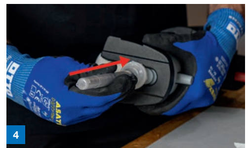
Material abwischen und OTTO Statikmischer ACF ORBIS 12-24X 10:1 aufsetzen
