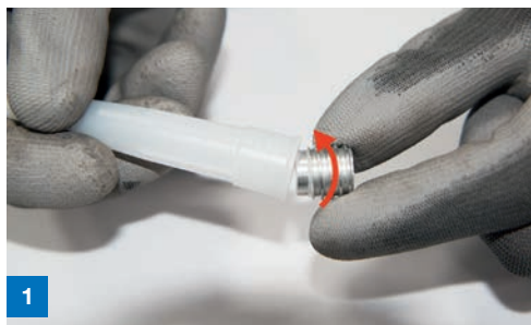
1 Den Gewindeaufsatz mit der ungefrästen Seite zuerst in das Innengewinde der Standardkartuschendüse schrauben
