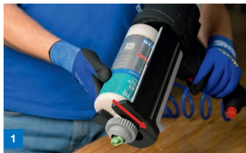
1 Einlegen der BlueLine Kartusche in die Pistole
