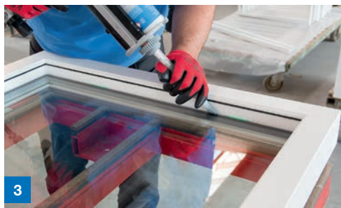
3 Befüllen des Falzgrundes mit Klebstoff
