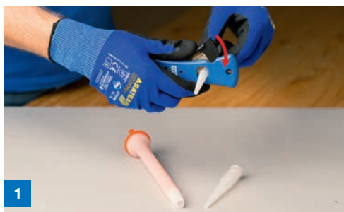
1 Standarddüse vor dem Aufschrauben nach Erfordernis kürzen
