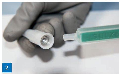
2 Eingeschraubter Gewindeaufsatz in der Standardkartuschendüse
