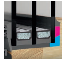
Überschlagsklebung auf Position 6
