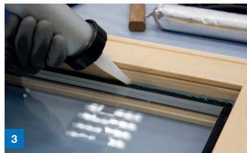
3 Abdichtung zwischen Flügelrahmen und Glashalteleiste auf Position 4
