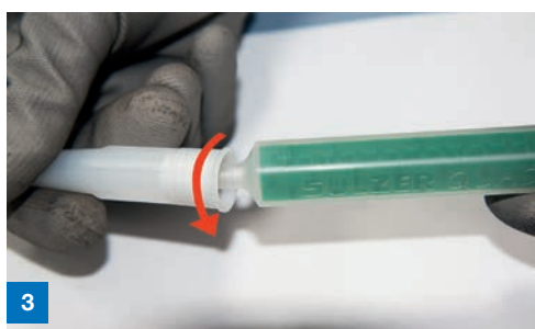
3 Standardkartuschendüse mit Gewindeaufsatz gerade auf die Statikmischerspitze aufsetzen und auf die glatte Fläche „aufschrauben“
