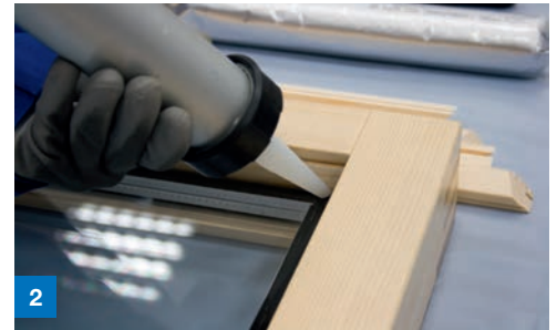
2 Abdichtung am Flügelrahmen hinter der Glashalteleiste
