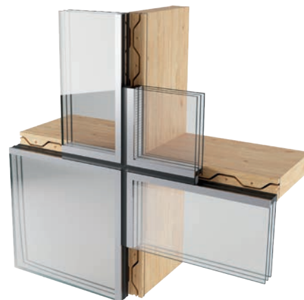
Schematischer Aufbau einer HGV-Fassade
