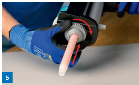
5 Statikmischer mit der Überwurfmutter fixieren
