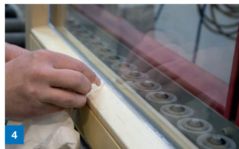
4 Reinigen des Rahmens und der Scheibe von Glättmittelrückständen (vor dem Antrocknen), um Schlieren – und damit dauerhafte Schäden am Glas – zu vermeiden. Verwenden Sie nur klares Wasser und ein weiches, fusselfreies Tuch.
