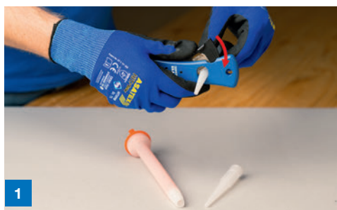
1 Standarddüse vor dem Aufschrauben nach Erfordernis kürzen
