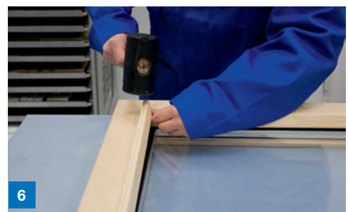
4 Oder: Abdichtung zwischen Flügelrahmen und Glashalteleiste flächig
