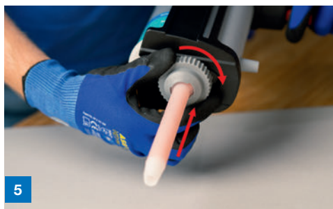
5 Statikmischer mit der Überwurfmutter fixieren
