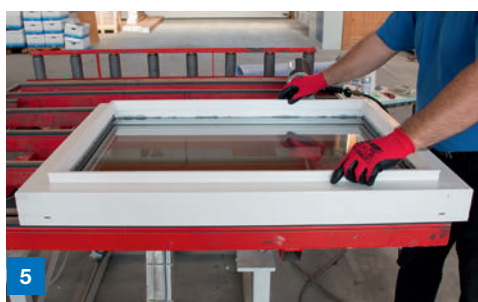
5 Einlegen der Glashalteleisten
