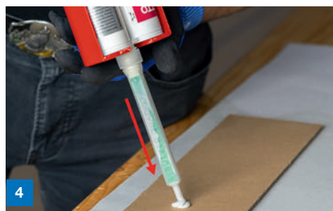
4 Den Statikmischer mit Klebstoff befüllen und Homogenität der Mischung prüfen (siehe Verarbeitungsbegleitende Qualitätskontrollen 2K-Produkte)
