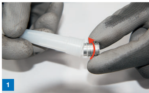
1 Den Gewindeaufsatz mit der ungefrästen Seite zuerst in das Innengewinde der Standardkartuschendüse schrauben
