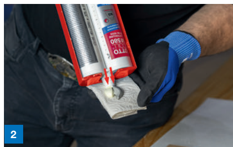
2 Material ohne Statikmischer ausdrücken, bis aus beiden Öffnungen Material austritt
