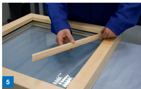
5 Einbringen der Glashalteleiste
