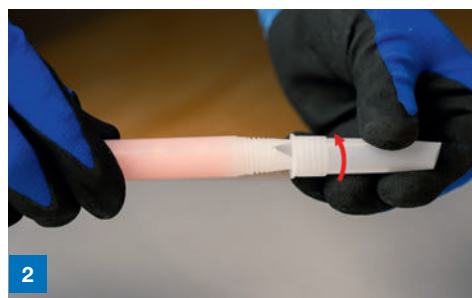
2 Standardkartuschendüse bis zum Anschlag auf den Statikmischer für BlueLine Kartuschen aufschrauben
