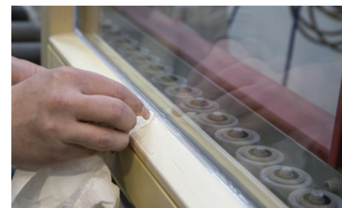
Nettoyage du cadre et de la vitre, de façon à retirer les résidus de produit de lissage
