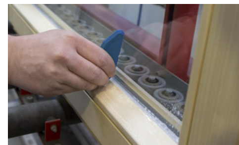
Il est possible de racle le mastic de la feuillure avec ou sans produit de lissage
