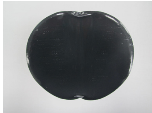
Zu erwartendes Mischbild bei Verarbeitung über eine Misch- und Dosieranlage
