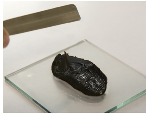
Konsistenz „kaugummiartig“, der Dichtstoff „zieht zurück“ ->Topfzeit ist erreicht
