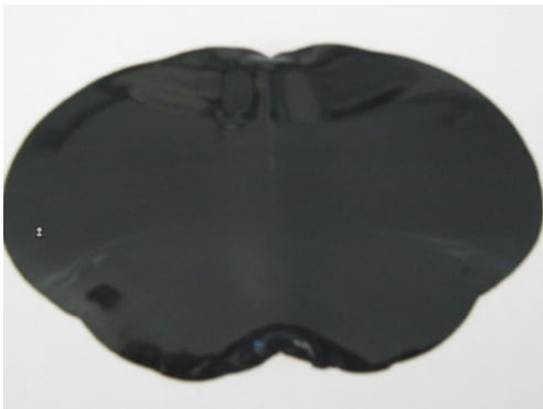
Papier auseinander ziehen - Zu erwartendes Mischbild bei Kartuschenverarbeitung
