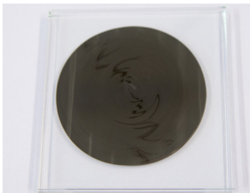
Glasplattentest – Zu erwartendes Mischbild bei Kartuschenverarbeitung
