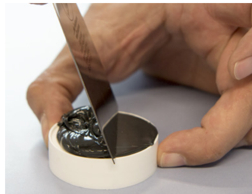
Dichtstoff glatt abziehen
