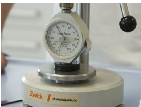
-> Messung der Shore A Härte mit einem Durometer!
