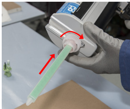
Statikmischer mit der Überwurfmutter fixieren
