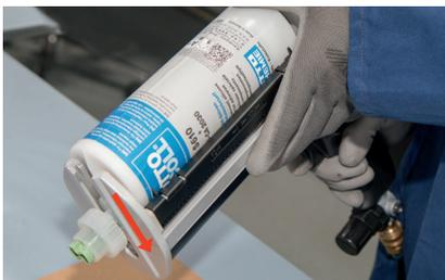
Einlegen der side-by-side Kartusche in die Pistole
