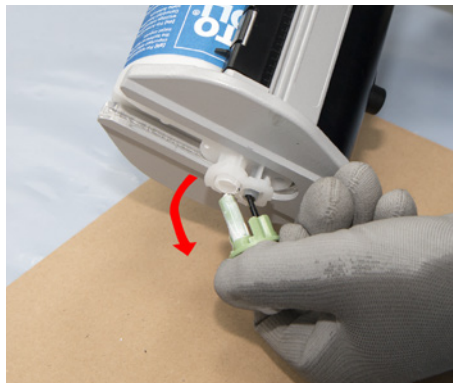
Überwurfmutter abschrauben und Stopfen entfernen
