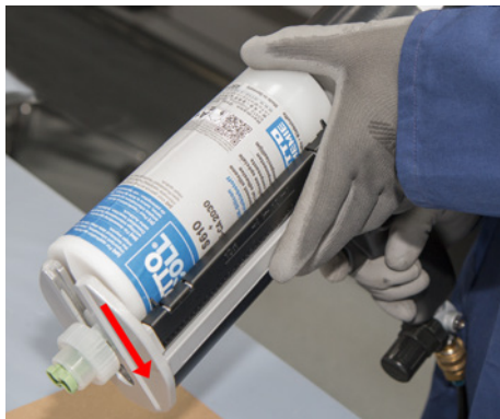
Einlegen der side-by-side Kartusche in die Pistole
