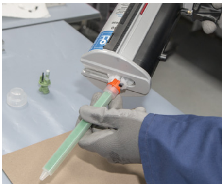
Material abwischen und Statikmischer aufsetzen
