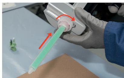
Statikmischer mit der Überwurfmutter fixieren
