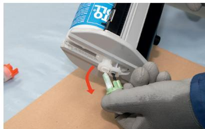
Überwurfmutter abschrauben und Stopfen entfernen
