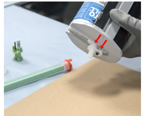
Material ohne Statikmischer ausdrücken, bis bei beiden Öffnungen Material austritt
