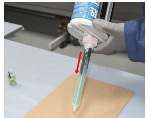
Befüllen des Statikmischers mit Klebstoff und Homogenität der Mischung prüfen (siehe Verarbeitungsbegleitende Qualitätskontrollen 2K-Produkte)
