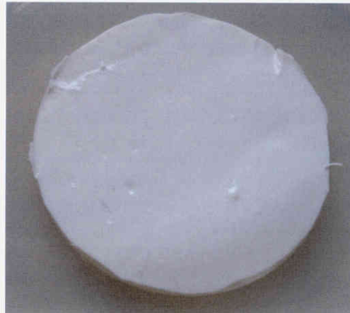
Foto 1: Untersuchungsmaterial OTTOSEAL® M 380 nach einer Inkubationszeit von 28 Tagen ohne sichtbaren Pilzbewuchs
