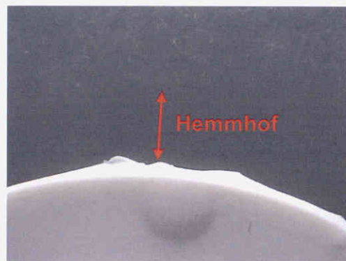
Foto 2: Untersuchungsmaterial OTTOSEAL® M 380 (6,5fach vergrößert) nach einer Inkubationszeit von 28 Tagen mit deutlichem Hemmhof
