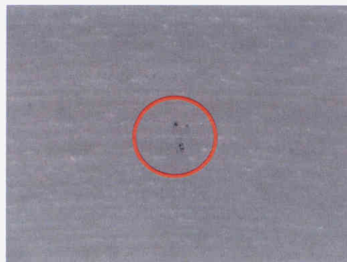
Foto 3: Untersuchungsmaterial OTTOSEAL® M 380 (50fach vergrößert) nach einer Inkubationszeit von 28 Tagen mit geringem Pilzwachstum
