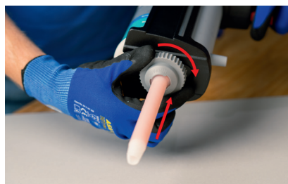
Statikmischer mit der Überwurfmutter fixieren
