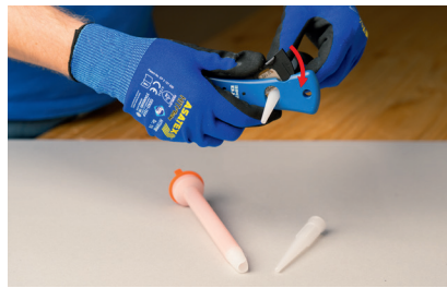
Standarddüse vor dem Aufschrauben nach Erfordernis kürzen
