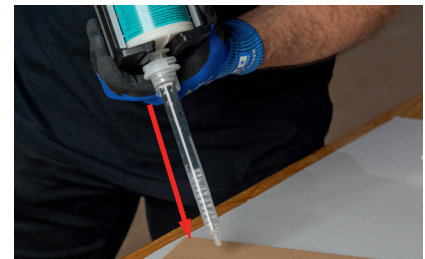
Befüllen des Statikmischers mit Klebstoff. Homogenität der Mischung prüfen (siehe Verarbeitungsbegleitende Qualitätskontrollen 2K-Produkte)
