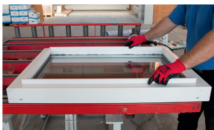
Einlegen der Glashalteleisten
