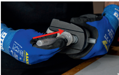
Material abwischen und OTTO Statikmischer ACF ORBIS 12-24X 10:1 aufsetzen
