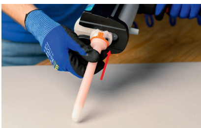
Material abwischen und Statikmischer aufsetzen
