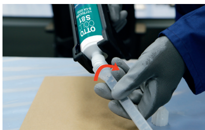
Material abwischen und OTTO Statikmischer MGQ 10-16D bis zum Anschlag aufschrauben
