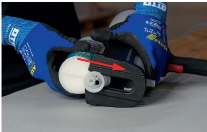
Einlegen der side-by-side Kartusche in die Pistole
