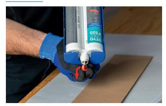
Einlegen der Kartusche in die Pistolenschale, Schutzkappe abschrauben und Stofen entfernen
