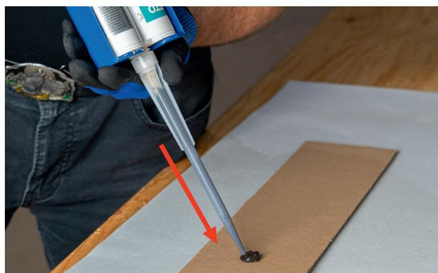
Befüllen des Statikmischer mit Klebstoff und Homogenität der Mischung prüfen (siehe Verarbeitungsbegleitende Qualitätskontrollen 2K-Produkte)
