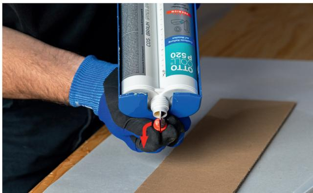
Einlegen der Kartusche in die Pistolenschale, Schutzkappe abschrauben und Stöfen entfernen
