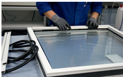
Einlegen der Glashalteleisten
