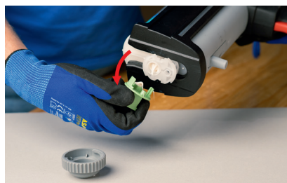
Überwurfmutter abschrauben und Stopfen entfernen
