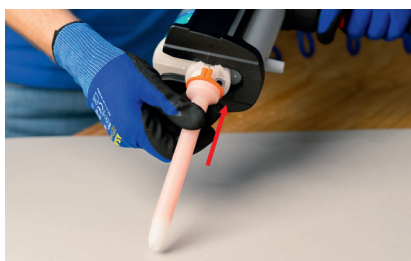
Material abwischen und Statikmischer aufsetzen
