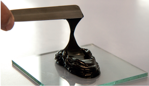
Konsystencja pastowata, nadająca się do smarowania -> Czas życia nie został jeszcze osiągnięty
