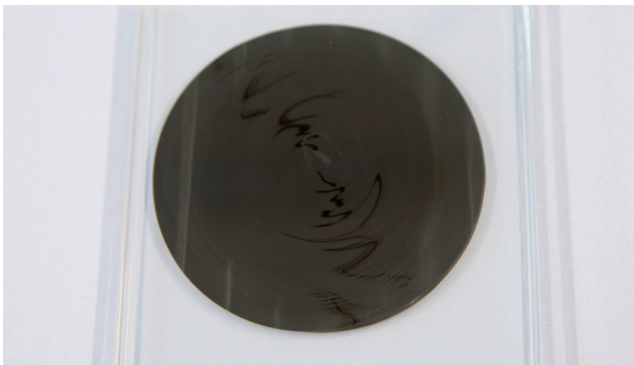
Konsystencja „gumy do żucia”, uszczelniacz „wycofuje się” -> Osiągnięto trwałość użytkową
