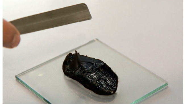
Konsystencja „gumy do żucia”, uszczelniacz „wycofuje się” -> Osiągnięto trwałość użytkową
