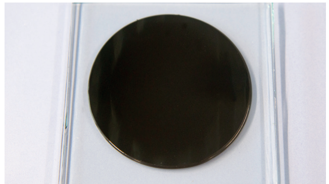
Test na płytce szklanej – oczekiwany wzór mieszania w przypadku przetwarzania przy użyciu systemu mieszania i dozowania
