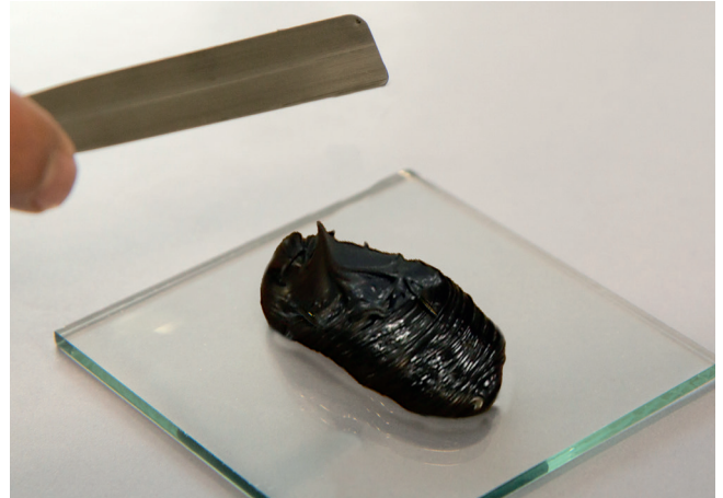
Consistentie "kauwgomachtig", de lijm "trekt terug" → pottijd is bereikt
