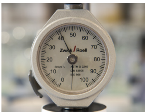
-> Mesure de la dureté Shore A avec un duromètre!
