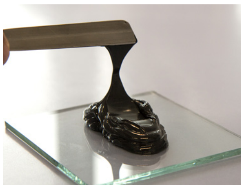
Consistance pâteuse, facile à étaler -> Le temps de conservation en pot n'est pas dépassé ->Pot life has been reached
