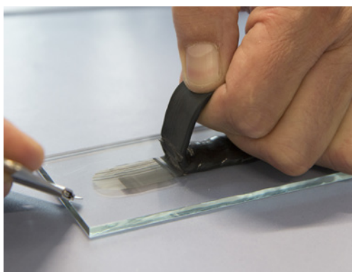
-> Décollement du boudin de colle et évaluation de la figure de casse! En cas de rupture de cohésion de la colle, l'adhérence au substrat est convenable.
