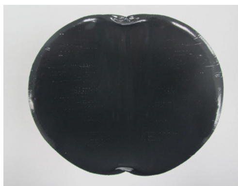
Aspect du mélange à attendre d'un traitement d'installation de mélange et de dosage
