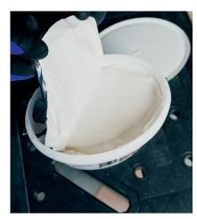
Nakon otvaranja kante, izvadite vrećicu s kuglicama za sušenje i izvucite film s jedne strane iz kante, uklanjajući sav stvrdnuti materijal ako je potrebno (nemojte ga miješati!). Ako ljepilo nije potrebno u cijelosti, ostavite vrećicu s kuglicama za sušenje i foliju za ponovno zatvaranje.
