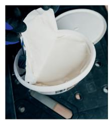
Après avoir ouvert le seau, retirer le sachet de billes sèches et tirer le film d'un côté du seau, enlever les durcissements si nécessaire (ne pas mélanger!). Si la colle n'est pas entièrement utilisée, conserver le sachet de billes sèches et le film pour le refermer.
