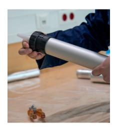
При обработке OTTOCOL<sup>®</sup> M 595 в сумке из алюминиевой фольги может использоваться ручной пресс или беспроводная пистолет, подходящий для фольги. Для этого откройте сумку из алюминиевой фольги, установите на нее сопло и вставьте в пистолет сумку из алюминиевой фольги с сопла. Как вариант, желаемое количество клея может быть удалено непосредственно из фольгированной сумки с помощью щетки или аналогичного средства. Дальнейшая обработка осуществляется с помощью зубчатых лопаток.
