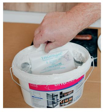
Om hergebruik van OTTOCOLL® M 595 te garanderen, moet de emmer luchtdicht worden afgesloten. Trek de lijm met een spatel in het midden enigszins omhoog en verwijder eventuele verhardingen. Leg de folie op de lijm en druk de rand licht aan. Druk vervolgens de verhoging in het midden vlak om eventuele luchtzakken te verwijderen. Druk de folie vast tot aan de rand, plaats het droogzakje en sluit de emmer. OTTOCOLL® M 595 is op deze manier optimaal afgesloten tot het volgende gebruik.
