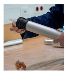
Voor de verwerking van OTTOCOLL® M 595 in alu foliezakken kan een hand- of accupistool worden gebruikt dat geschikt is voor foliezakken. Open hiervoor de alu foliezak, plaats de spuitmond voor foliezakken erop en plaats de alu foliezak met spuitmond in het pistool. Als alternatief kan de gewenste hoeveelheid lijm ook direct vanuit de foliezak worden aangebracht met behulp van een spatel. Vervolgens wordt het materiaal verder verwerkt met een getande spaan.
