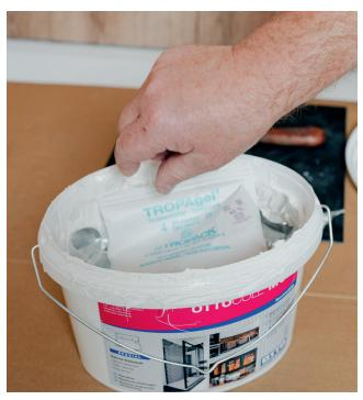
Для обеспечения повторного использования OTTOCOL® M 595 требуется герметичное закрытие ведра. Для этого используйте шпатель, чтобы натянуть клей в небольшом подъеме в середине ведра и удалить любое закалывание. Поместите фольгу на клейкий материал и слегка прижимайте к краю. Затем сровняйте поднятую область в середине, чтобы удалить любые воздушные капли. Затем прижимайте фольгу к краю, вставьте сухие шарики и закройте ведро. OTTOCOL® M 595 идеально закрыт для следующего применения.
