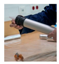
Do aplikacji OTTOCOLL® M 595 w aluminiowym worku foliowym można użyć prasy ręcznej lub pistoletu bezprzewodowego odpowiedniego do worków foliowych. W tym celu należy otworzyć worek z folii aluminiowej, umieścić dyszę worka na górze i włożyć worek z folii aluminiowej z dyszą worka do pistoletu. Alternatywnie, żądaną ilość kleju można rozprowadzić bezpośrednio z torebki z folii aluminiowej za pomocą szpatułki lub podobnego narzędzia. Dalsza obróbka odbywa się za pomocą pacy zębatej.
