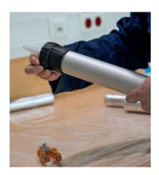
При обробці ОТТОСОЦ<sup>®</sup> М 595 в мішку з алюмінієвої фольги можна використовувати ручний прес або акумуляторний пістолет, придатний для мішків з фольги. Для цього відкрийте мішок з алюмінієвої фольги, помістіть насадку мішка зверху і вставте мішок з алюмінієвої фольги з насадкою мішка в пістолет. Як варіант, потрібну кількість клею можна зняти безпосередньо з фольгованого мішка шпателем або подібним. Потім проводиться подальша обробка зубчастим шпателем.
