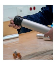
Bei der Verarbeitung von OTTOCOLL® M 595 im Alu-Folienbeutel kann eine für Folienbeutel geeignete Handpressoder Akku-Pistole verwendet werden. Zu diesem Zweck ist der Alu-Folienbeutel zu öffnen, die Beuteldüse oben aufzusetzen und der Alu-Folienbeutel mit Beuteldüse in die Pistole einzulegen. Alternativ kann die gewünschte Menge Klebstoff direkt aus dem Folienbeutel mit Hilfe eines Spachtels o. ä. ausgestrichen werden. Anschließend erfolgt die Weiterverarbeitung per Zahnspachtel.
