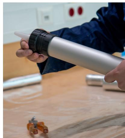
Prilikom obrade OTTOCOLL® M 595 u vrećici od aluminijске folije, može se koristiti ručna preša ili pištolj na baterije prikladan za vrećice od folije. U tu svrhu potrebno je otvoriti vrećicu od aluminijске folije, staviti mlaznicu vrećice na vrh i vrećicu od aluminijске folije s mlaznicom staviti u pištolj. Alternativno, željena količina ljepila može se rasporediti izravno iz folijske vrećice pomoću lopatice ili sličnog alata. Daljnja obrada se zatim izvodi nazubljenom lopaticom.
