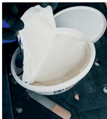
Open de emmer en verwijder het zakje met droogkorrels; pak de folie aan de rand beet en trek deze uit de emmer. Verwijder eventuele verharding (niet omroeren!). Als de lijm niet in zijn geheel nodig is, droogzakje en folie bewaren voor gebruik bij het wederom sluiten.
