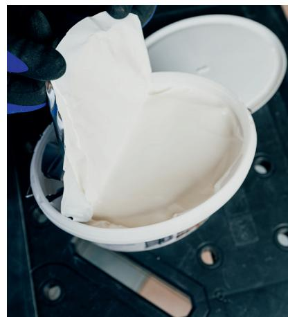
Nach dem Öffnen des Eimers den Beutel mit Trockenperlen entfernen und die Folie von einer Seite aus dem Eimer ziehen, ggf. Aushärtungen entfernen (nicht unterrühren!). Falls der Klebstoff nicht komplett benötigt wird, Beutel mit Trockenperlen und Folie zum Wiederverschließen aufbewahren.
