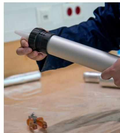
Bei der Verarbeitung von OTTOCOLL® M 595 im Alu-Folienbeutel kann eine für Folienbeutel geeignete Handpress- oder Akku-Pistole verwendet werden. Zu diesem Zweck ist der Alu-Folienbeutel zu öffnen, die Beuteldüse oben aufzusetzen und der Alu-Folienbeutel mit Beuteldüse in die Pistole einzulegen. Alternativ kann die gewünschte Menge Klebstoff direkt aus dem Folienbeutel mit Hilfe eines Spachtels o. ä. ausgestrichen werden. Anschließend erfolgt die Weiterverarbeitung per Zahnpachtel.
