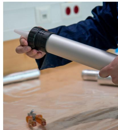
При обробці OTTOCOLL® M 595 в мішку з алюмінієвої фольги можна використовувати ручний прес або акумуляторний пістолет, придатний для мішків з фольги. Для цього відкрийте мішок з алюмінієвої фольги, помістіть насадку мішка зверху і вставте мішок з алюмінієвої фольги з насадкою мішка в пістолет. Як варіант, потрібну кількість клею можна зняти безпосередньо з фольгованого мішка шпателем або подібним. Потім проводиться подальша обробка зубчастим шпателем.
