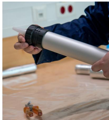
При обработке OTTOCOLL® M 595 в сумке из алюминиевой фольги может использоваться ручной пресс или беспроводная пистолет, подходящий для фольги. Для этого откроите сумку из алюминиевой фольги, установите на нее сопло и вставьте в пистолет сумку из алюминиевой фольги с сопла. Как вариант, желаемое количество клея может быть удалено непосредственно из фольгированной сумки с помощью щетки или аналогичного средства. Дальнейшая обработка осуществляется с помощью зубчатых лопаток.
