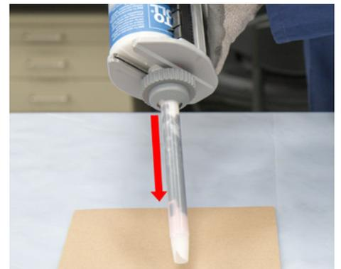
Llenar el mezclador estático con adhesivo. Comprobar la homogeneidad de la mezcla (véanse los controles de calidad del acompañante del tratamiento para productos de dos componentes)
