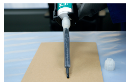
Skontrolować wyprowadzaną warstwę i jednolitość mieszanki (patrz towarzyszące przygotowaniu kontrole jakości produktów 2-komponentowych)
