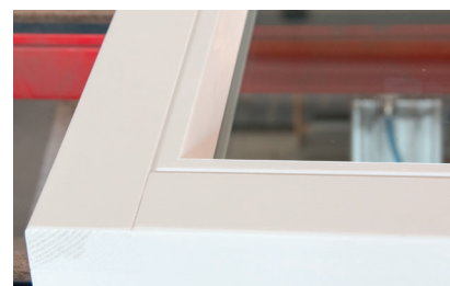
Wciągnięcie uszczelki szklenia
