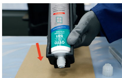
Włożenie kartusza współosiowego do pistoletu
