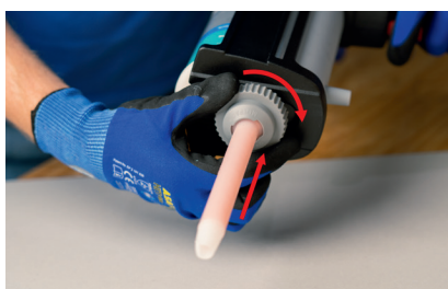
Ustalić położenie mieszacza statycznego nakrętką złączkową
