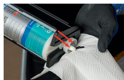
Wyciskać materiał bez mieszacza statycznego, dopóki nie będzie wydostawać się z obu otworów
