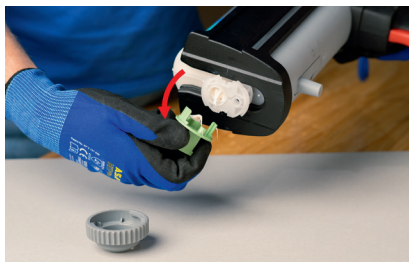
Dévisser l'écrou de raccord et retirer le bouchon
