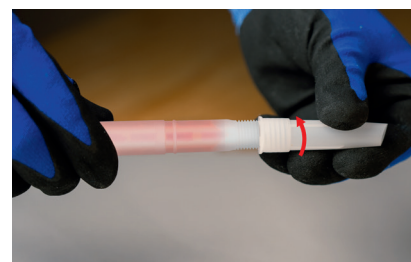
Visser la canule pour cartouche standard sur le mélangeur statique pour les cartouches BlueLine jusqu'à la butée
