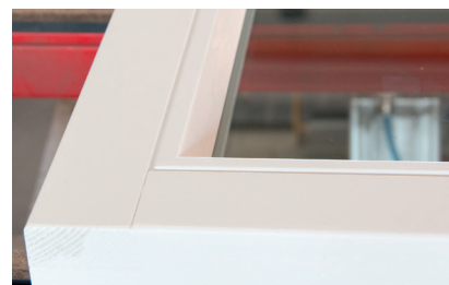
Insertion du joint de vitrage
