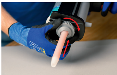
Fixer le mélangeur statique avec l'écrou de raccordement
