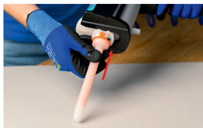
Essuyer le matériau et poser le mélangeur statique
