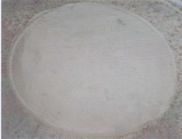
Foto 1: Untersuchungsmaterial OTTOSEAL® S 69 Foto 1: nach einer Inkubationszeit von zweimal 28 Tagen: Mit dem bloßen Auge ist kein Pilzwachstum sichtbar.
