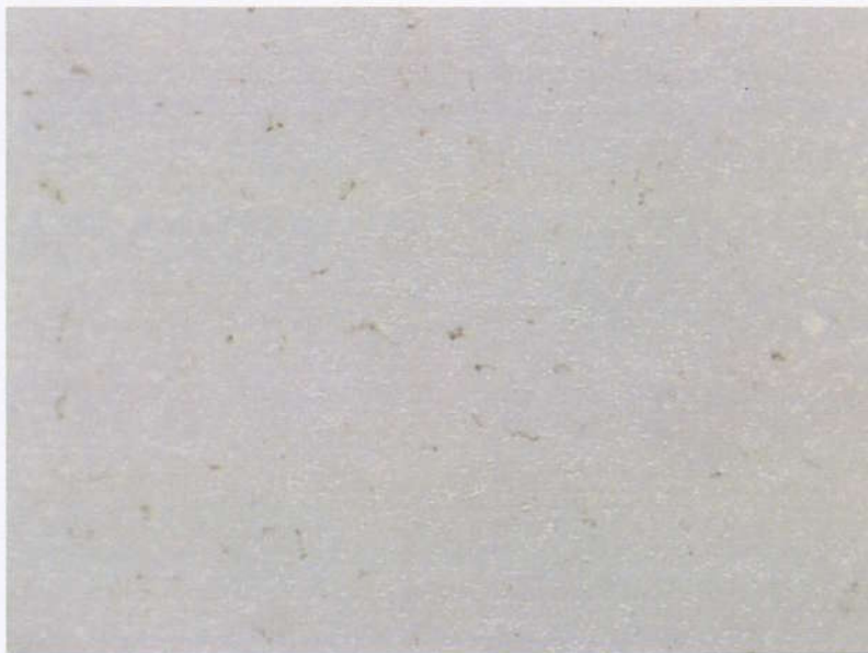
Foto 2: Untersuchungsmaterial OTTOSEAL® S 69 nach einer Inkubationszeit von zweimal 28 Tagen: Unter dem Mikroskop bei 50facher Vergrößerung ist ein starkes Pilzwachstum sichtbar.
