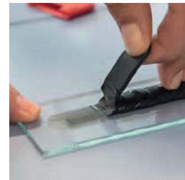
>>12: Prüfen der Haftung – Raupe auftragen. an Grenzfläche einschneiden, abziehen und Bruchbild prüfen (v.l.n.r.) (Bilder: Hermann Otto GmbH)
