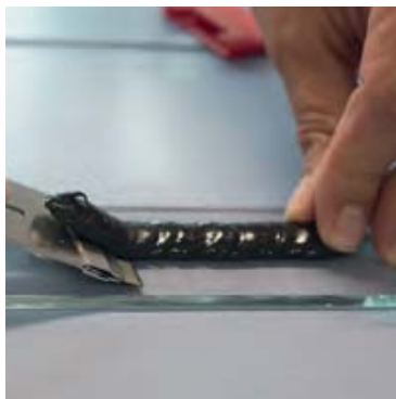
>>12: Prüfen der Haftung – Raupe auftragen. an Grenzfläche einschneiden, abziehen und Bruchbild prüfen (v.l.n.r.) (Bilder: Hermann Otto GmbH)
