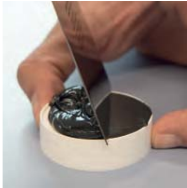
>>11: Prüfen der Aushärtung – Klebstoff einbringen, abziehen – glatte Oberfläche, Shore-A-Härte messen (v.l.n.r.)
