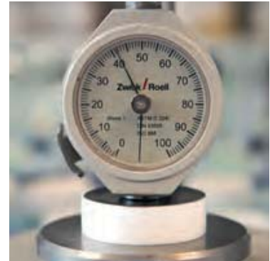
>>11: Prüfen der Aushärtung – Klebstoff einbringen, abziehen – glatte Oberfläche, Shore-A-Härte messen (v.l.n.r.)
