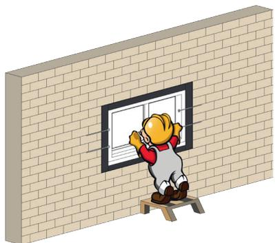
Séquence 6 : insérer le châssis de fenêtre dans l'ouverture, l'aligner et le fixer.
