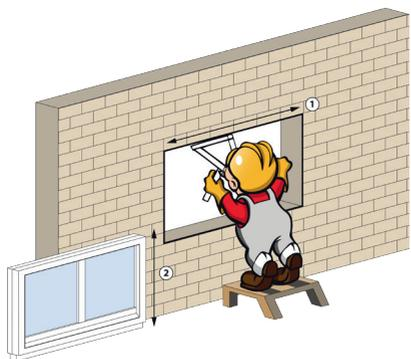
Séquence 1 : mesurer l'ouverture pratiquée dans le mur, ainsi que le châssis de la fenêtre.
