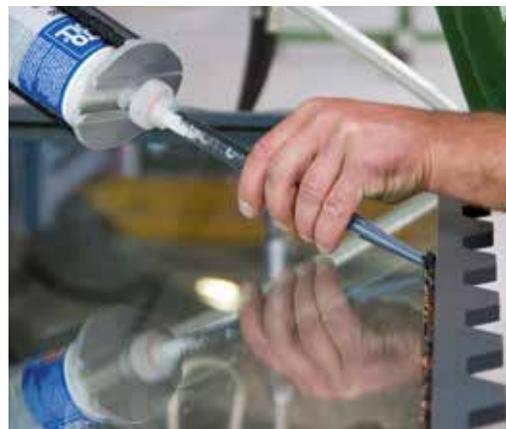
Einbringen des 2K Silicons für Holz-Glas-Verbundelemente
