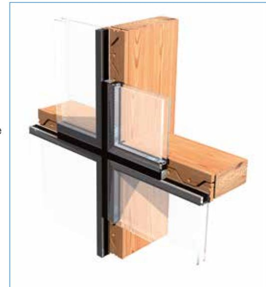
Aufbau eines HGV-Elementes
