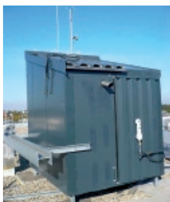
Die Testeinheit mit Wand und Fassadenelement fertig montiert.
