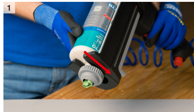
1 Einlegen der BlueLine Kartusche in die Pistole
