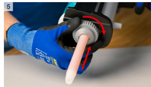
5 Statikmischer mit der Überwurfmutter fixieren
