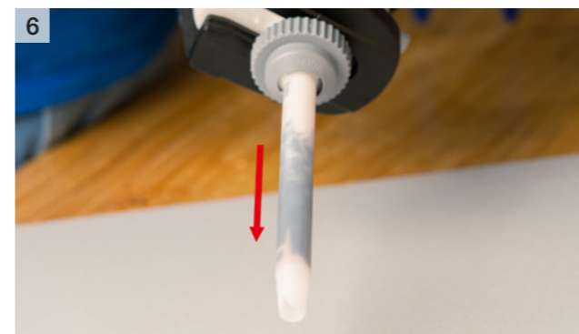
6 Befüllen des Statikmischer mit Klebstoff. Homogenität der Mischung prüfen (siehe verarbeitungsbegleitende Qualitätskontrollen 2K-Produkte)
