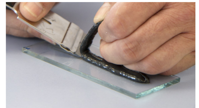
Einschneiden zwischen Klebstoff und Glasscheibe
