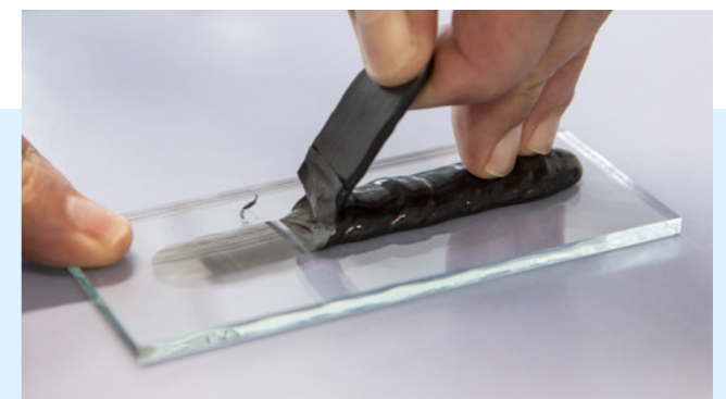
Abziehen der Klebstoffraupe und Beurteilung des Bruchbildes: Wenn es zu einem Kohäsionsbruch im Klebstoff kommt, ist die Haftung zum Substrat einwandfrei
