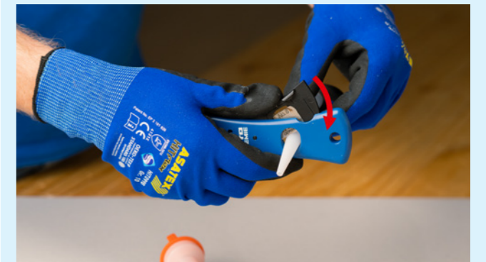
Standarddüse vor dem Aufschrauben nach Erfordernis kürzen
