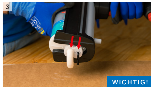
3 Material ohne Statikmischer ausdrücken, bis aus beiden Öffnungen Material austritt
