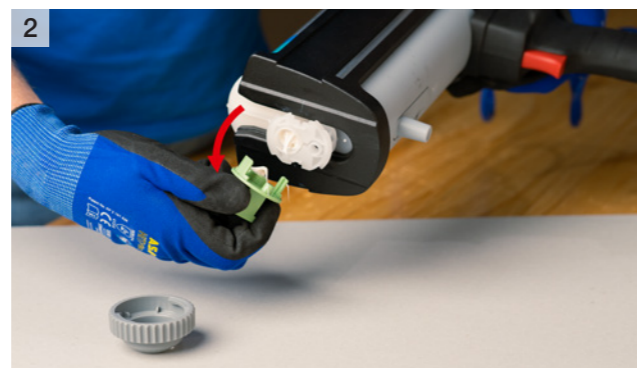
2 Überwurfmutter abschrauben und Stopfen entfernen
