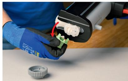
Überwurfmutter abschrauben und Stopfen entfernen
