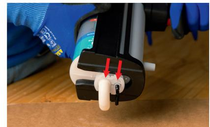
Material **ohne** Statkmischer ausdrücken, bis bei **beiden** Öffnungen Material austritt
