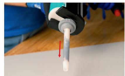
Befüllen des Statkmischer mit Klebstoff. Homogenität der Mischung prüfen (siehe Verarbeitungs begleitende Qualitätskontrollen 2K-Produkte)
