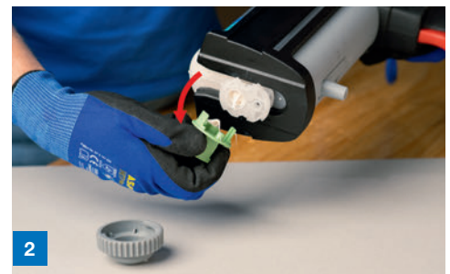
2 Überwurfmutter abschrauben und Stopfen entfernen
