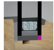
Abdichtung am Flügelrahmen hinter der Glashalteleiste
