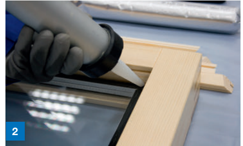
2 Abdichtung am Flügelrahmen hinter der Glashalteleiste
