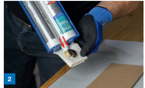
2 Material ohne Statikmischer ausdrücken bis bei beiden Öffnungen Material austritt
