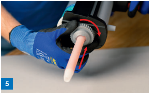
5 Statikmischer mit der Überwurfmutter fixieren
