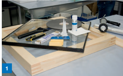
1 Vorbereiten der Abdichtung
