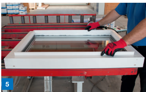
5 Einlegen der Glashalteleisten
