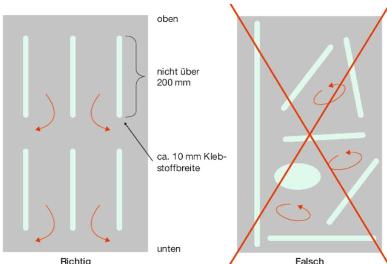
Bei der Klebung an Decken und bei der Klebung an Wände (wenn die Oberkante des Glases 4 m über der Bodenfläche liegt),
