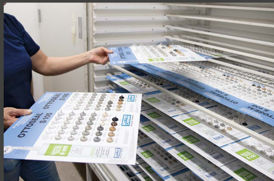
◀ Nach dem Auftupfen des Silicons kommen die Farbmustertafeln in einen Trockenschrank.
